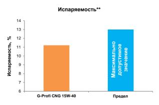
G-Profi CNG 15W-40 имеет сниженную испаряемость и уменьшенный расход масла на угар, снижает затраты на смазочный материал
